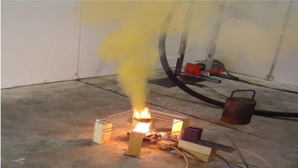
Bild 10. Versuchsaufbau mit gezündetem Rauchpulver.
