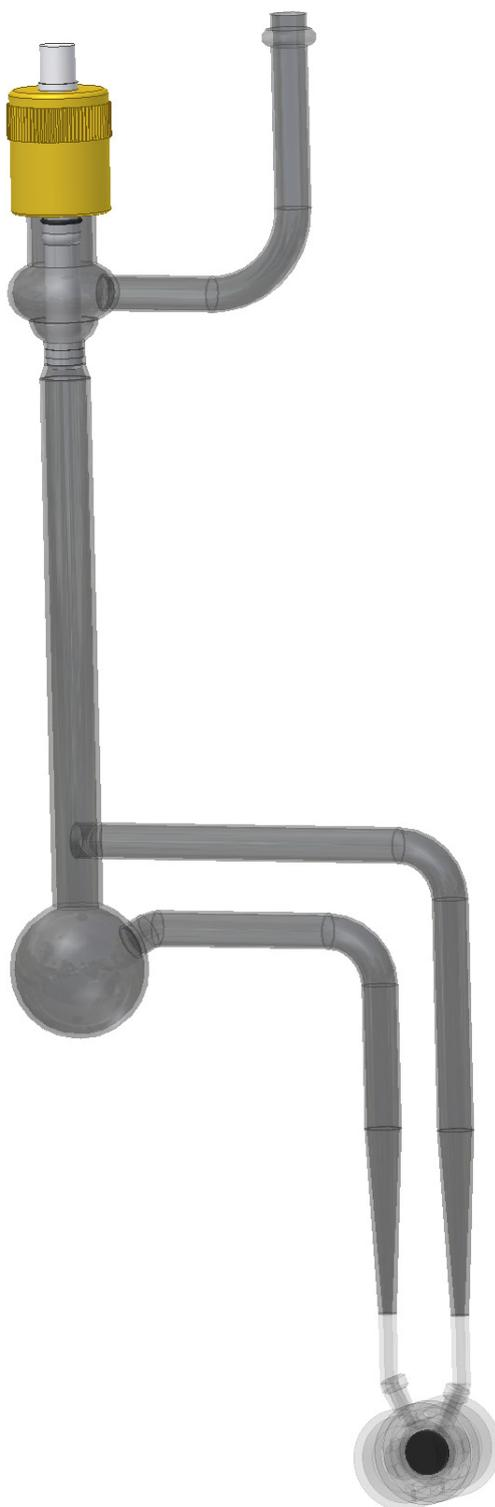
**Abbildung 3.8:** Duranglas-Kolben mit angelegter Quarzglas-Küvette zur Messung von  $C_{60}^- / C_{60}^{2-}$  in THF.
