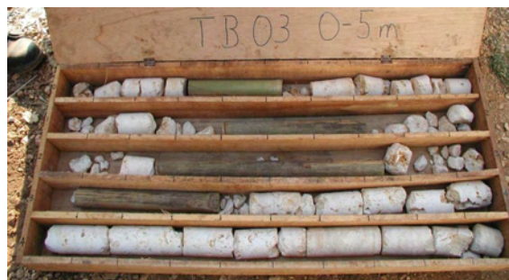
Abb. 9: Kernstrecke einer Vertikalbohrung in die Sohle der Höhle
