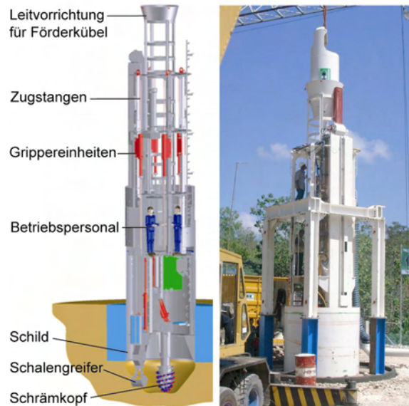
Abb. 8: Schachtabsenkanlage der Herrenknecht AG [4]
