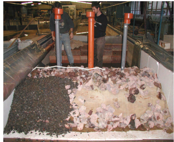
Abb. 18: Dammschüttung aus Wasserbausteinen und Kies mit Textillage
