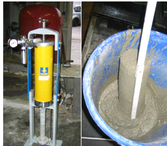
Abb. 4: Messung der Frischbetonstabilität mit der BAUER-Filterpresse; rechts: Filterkuchen
