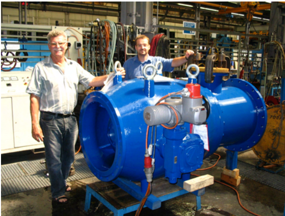
Abb. 11: Endabnahme der Grundablassarmatur (Ringkolbenventil) im VAG-Werk Mannheim (2006)
