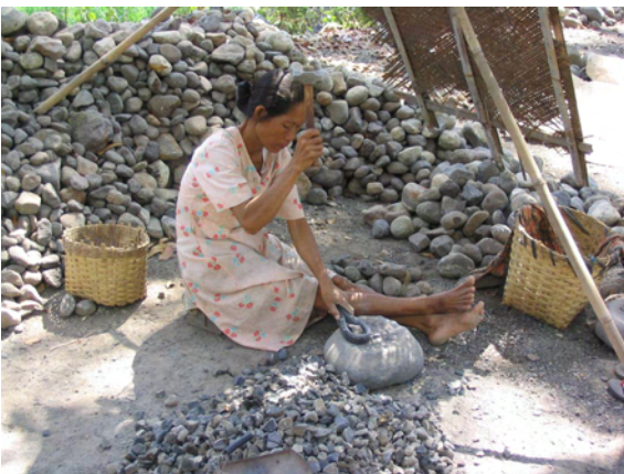
Abb. 16: Händische Herstellung und Sortierung von Gesteinskörnungen unterschiedlicher Fraktionen
