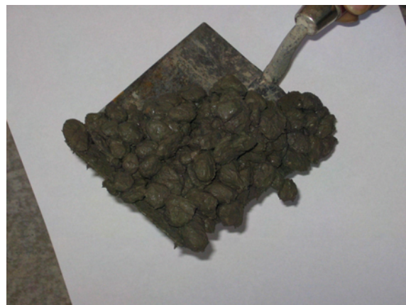
Abb. 14: Dränbeton mit hohem Gehalt an Stabilisierer "klebt" an der Kelle
