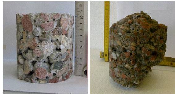
Abb. 13: Im Labor hergestellte und aus dem Pfahl entnommene Probe unter Verwendung des gleichen Ausgangsmaterials
