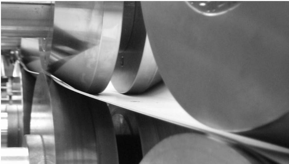
Abbildung 48: Wellenförmiger Verlauf des Biegewinkels (Versuchsanlage PtU, TU Darmstadt)
