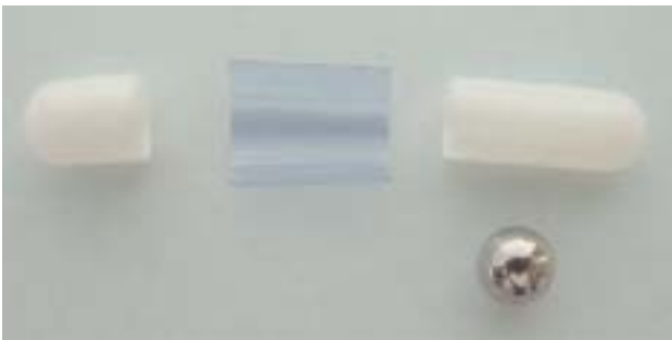
Abb. 10: Dosimeter für die Messung der Tiefendosisverteilung im Schüttgut (z.B. Weizen)
