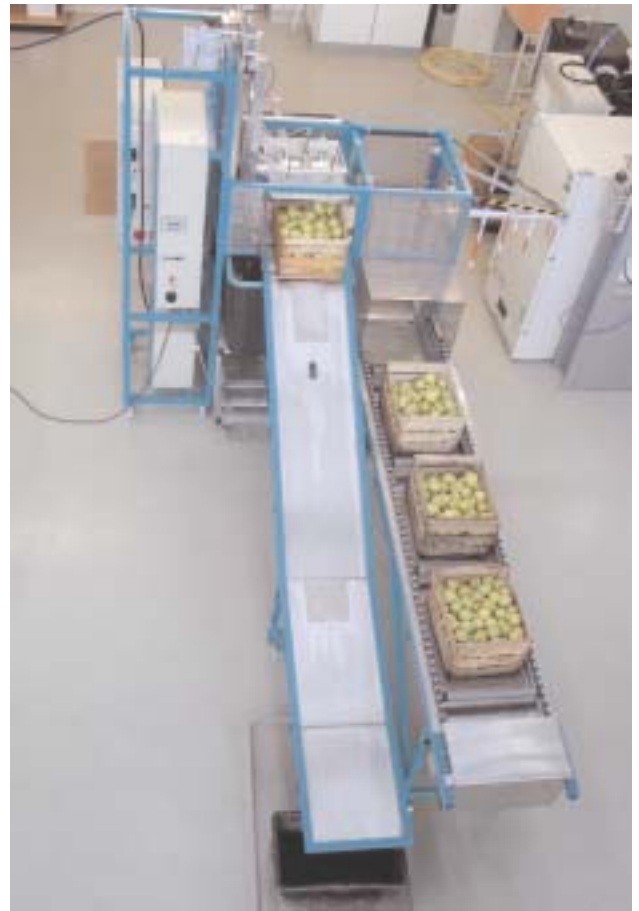
Abb. 3: Optimierte Heißwassertauchanlage für den (halb-)kontinuierlichen Betrieb
