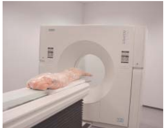
Abb. 3: Der Röntgen-Computertomograph mit aufgelegter Schweinehälfte
