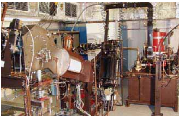
Abb. 9: Elektronenlinearbeschleuniger (CIRCE III) der BfEL
