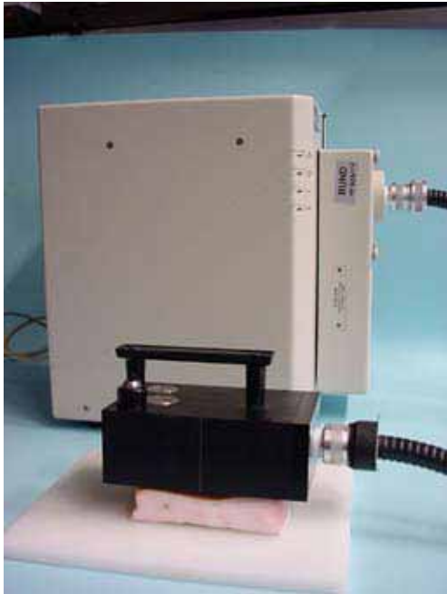
Abb. 4: Die Basiskomponenten der scannenden NIR-Geräte sind immer gleich und umfassen den Monochromator, der den monochromen Lichtstrahl für die Messung erzeugt, und den Detektor, der den nach der Reflexion in seinem Spektrum veränderten Lichtstrahl misst. Im PC werden die Messdaten nach Programmvorgaben umgesetzt. Vorteil des Gerätes ist der mobile Messkopf, der über eine relativ große Fläche hinweg Spektren nativ belassener Gewebe erfasst.
