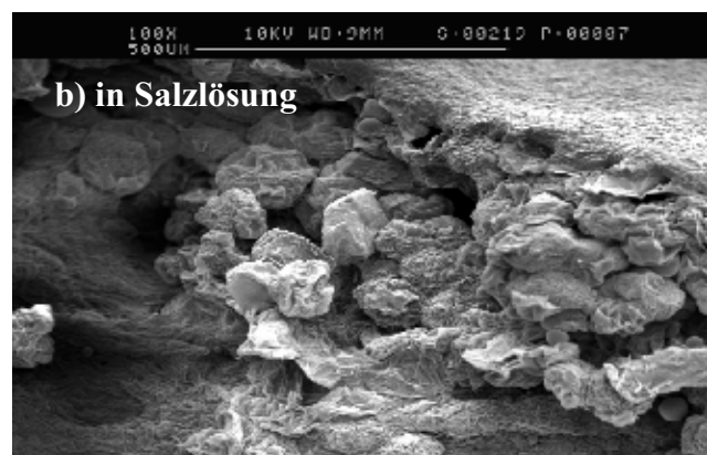
Abb. 1: Rasterelektronenmikroskopische Aufnahme frittiertes Kartoffelstäbchen: (a) Kontrolle (b) osmotisch vorbehandelte Probe
