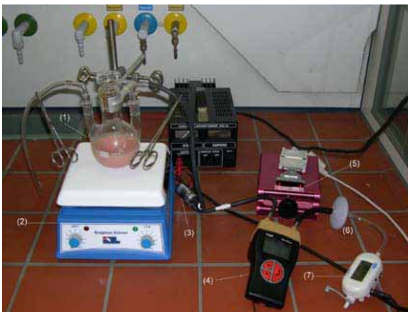
Abb. 8: Versuchsaufbau zur Bestimmung von CO im Fischfleisch
