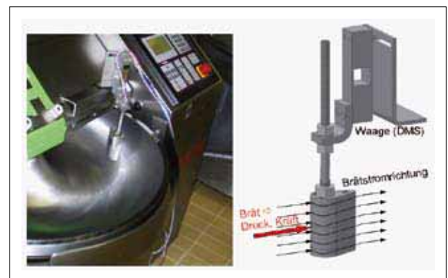
Abb. 3: Anströmkraft des Brätes: System Eintauchsonde/ Waage
