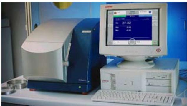
Abb. 7: NIT- System FoodScan™ Lab; Nahinfrarot-Bereich 850-1050 nm
