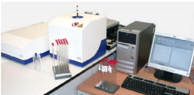
Abb. 8: Elektronen-Spin-Resonanz-Spektrometer (e-scan™, Fa. Bruker)
