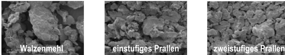
Abb. 2: REM-Aufnahmen der Mehle nach Walzen- und Prallmahlverfahren
