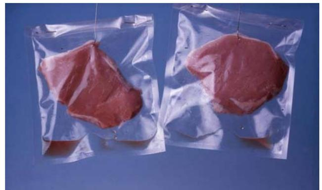
Abb. 9: Konventionelle Messung des Tropfsaftverlustes
