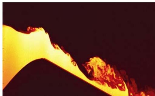
*Mittels Laser-Induzierter Fluoreszenz (LIF) Technik aufgenommene Bildsequenz aus einem Laborexperiment an einer Zweischichten Austauschströmung über einer Sohlschwelle.*
