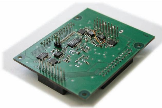
**Abbildung 7.1: Prototyp des analogen Frontends**
