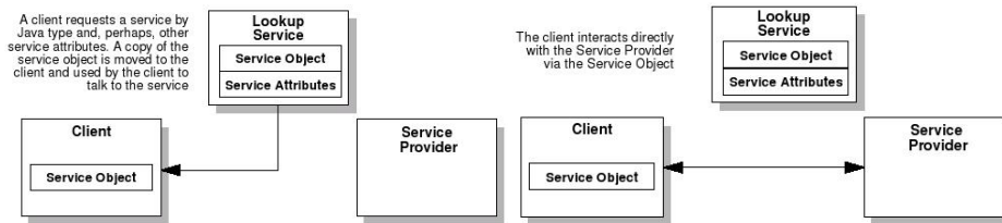
Abbildung 5. Suche eines Lookup service in JINI [3] Abbildung 6. Registrierung eines Service-Objektes [3]
