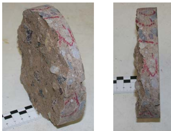
Bild 4.1: Modifizierter Spaltzugversuch an Bohrkernen oben: Prinzipdarstellung unten: minimale Dicke der abspaltbaren Scheiben
