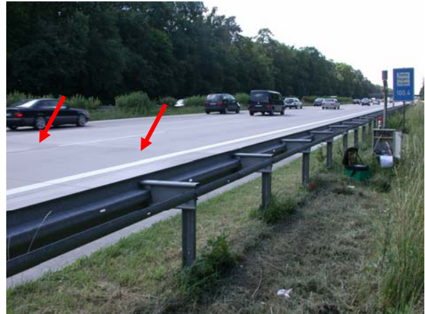
Bild 3.1: Ansicht der Messstelle (Blick Richtung Süden); die roten Pfeile markieren die Orte der Temperaturmessung in der Fahrbahndecke; rechts im Bild ist der Schutzkasten für die Datenerfassungseinheit und die Stromversorgung sowie der Mast mit den Sensoren für die Erfassung der Lufttemperatur und der relativen Luftfeuchte zu erkennen
