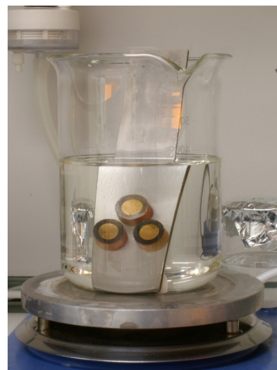
Abb. 5-6 Halterung für die Entwicklung und Tauchentwicklung im Becherglas
