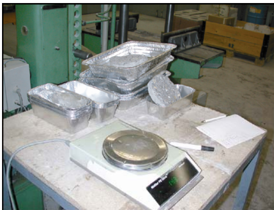
Bild 6.10: Ermittlung des massenbezogenen Wassergehalts der Scheiben; links: Probenwägung; rechts: Probentrocknung im Ofen
