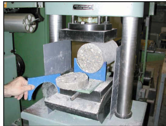
Bild 6.9: Modifizierte Spaltzugbeanspruchung durch halbkreisförmige Manschetten zur Spaltung der zylinderförmigen Proben senkrecht zur Zylinderachse
