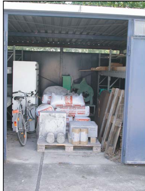
Bild 6.12: Lagerung der 50 \times 50 \times 20 \text{ cm}^3 Betonproben sowie der zylinderförmigen Vergleichsproben im Freien horizontal und vertikal sowohl mit (rechts) als auch ohne Überdachung (links)
