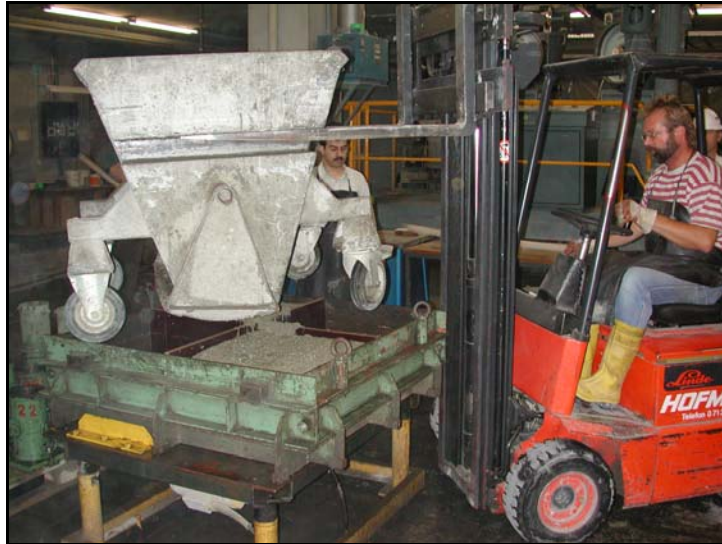
Bild 6.11: Herstellung der 50 \times 50 \times 20 \text{ cm}^3 Betonplatten
