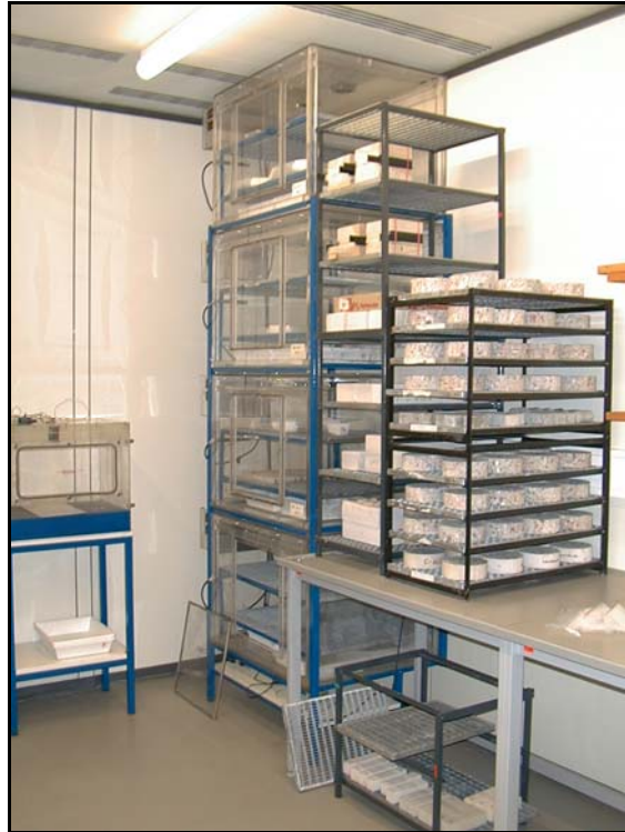
Bild 6.7: Vier übereinander liegende Klimakammern mit konstanten relativen Luftfeuchten von 33 %, 54 %, 75 % und 94 % und einer konstanten Temperatur von 20 °C
