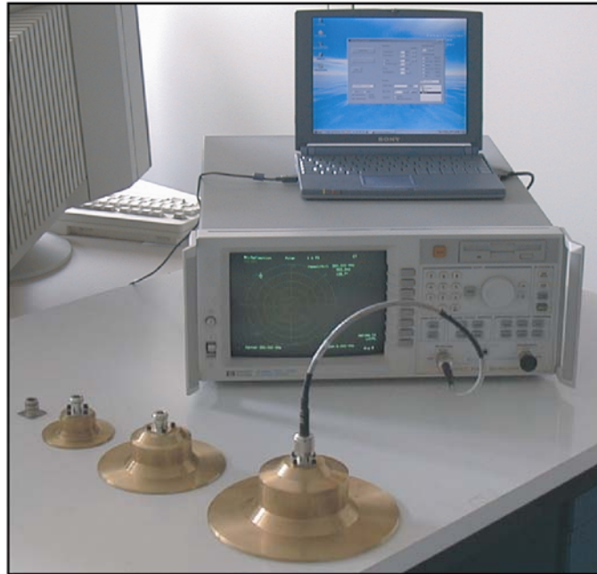
Bild 5.4: Messplatz zur Bestimmung der Permittivitätszahl. Im Bild sind der Netzwerkanalysator (HP 8712 ET), ein Notebook zur Steuerung und die Sensoren A, B, C und D (von links nach rechts) zu erkennen. Die Radien der Sensoren sind in Tabelle 5.1 angegeben
