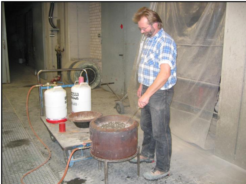
Bild 9.1: Bestimmung des Wassergehalts von Frischbeton durch die Darrmethode nach DIN 52171 [31]
