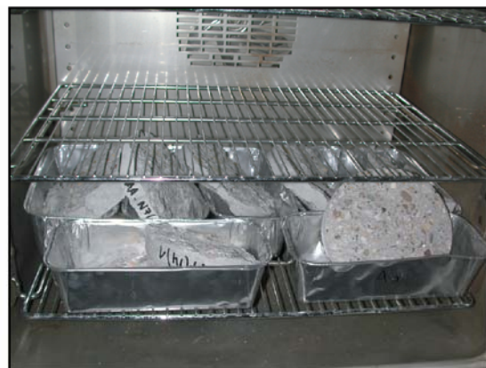
Bild 6.10: Ermittlung des massenbezogenen Wassergehalts der Scheiben; links: Probenwägung; rechts: Probentrocknung im Ofen
