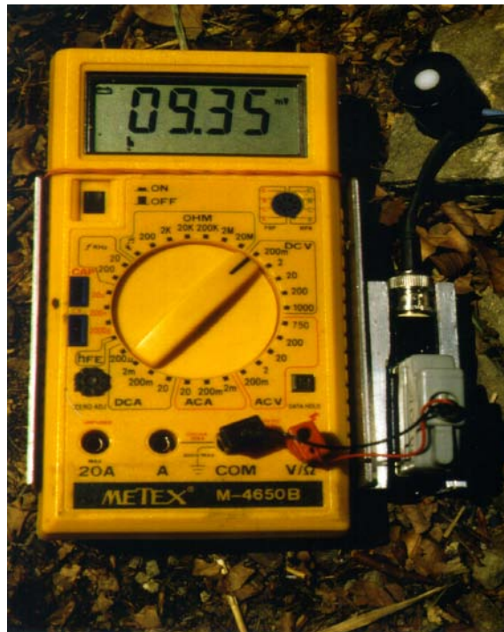
Abb. 2.6: Quantensensor Li-Cor LI 190SB zur Messung der photosynthetisch aktiven Strahlung (PAR: 400 - 700 nm) am Standort. Die mit dem Meßkopf ermittelten Daten werden über ein handelsübliches Multimeter in mV angezeigt. 1 mV entspricht 192 \mu\text{mol m}^{-2} \text{s}^{-1} (hier: Messung vom 5.8.1998 in der Sonne 9,35 \text{ mV} = 1795 \mu\text{mol m}^{-2} \text{s}^{-1} ).
