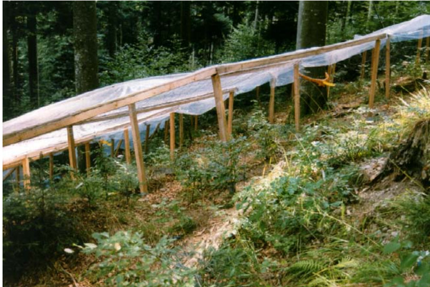
Abb. 2.4: Die zur Erzeugung von Trockenstreiß erstellte Überdachung mit UV-durchlässiger Folie.
