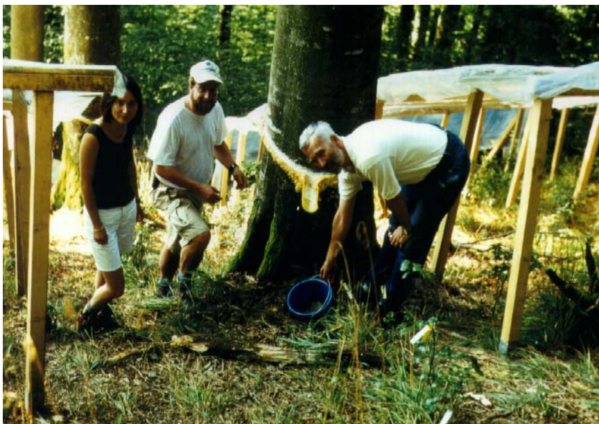
Abb. 2.8: Um Wassereintrag in die Trockenfläche zu verhindern, wurde das am Stamm der großen Bäume abfließende Wasser über eine Manschette in einen Eimer geleitet, der von Zeit zu Zeit abseits entleert wurde. Von links: C. Volkmer, O. Wenzel, C. Buschmann
