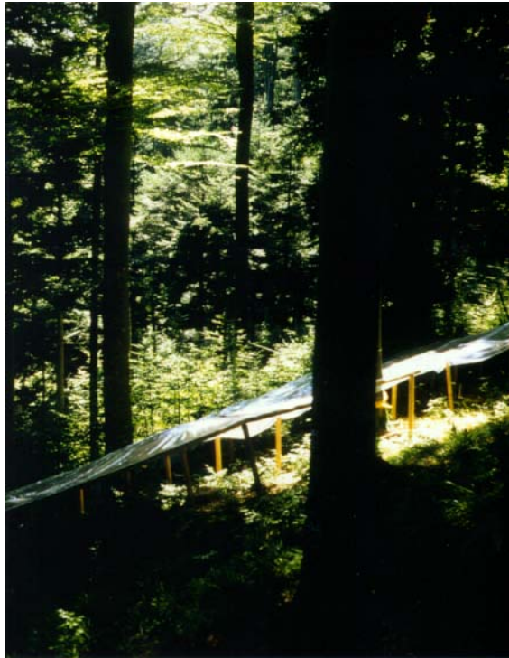
Abb. 2.2: Temporäre Beschattung der 41,5 % steilen Versuchsfläche.
