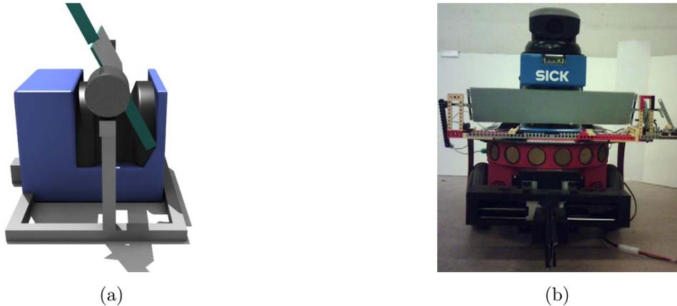
Abbildung 2.8: 3D-Datenaufnahme mit Zeilenscanner mit Hilfe eines rotierenden Spiegels
