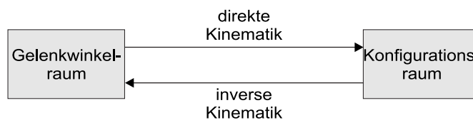
Bild 1.1: Direktes und inverses kinematisches Problem
