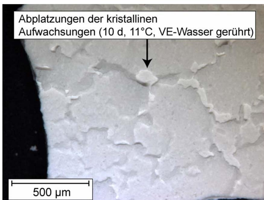
**Abbildung 68:** Lichtmikroskopische Aufnahme der Oberfläche einer Zementsteinscheibe, Exposition über 10 d, gerührt in 0,5 L VE-Wasser (11°C)
