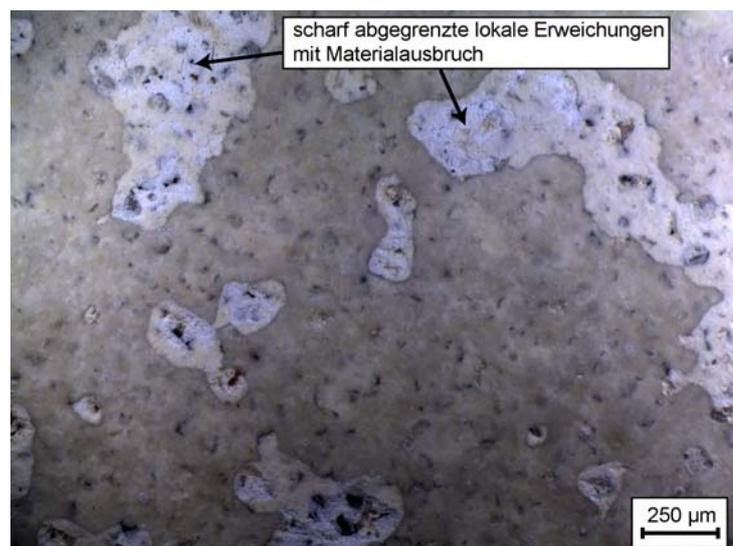
**Abbildung 29:** Lichtmikroskopische Aufnahme von weißen Flecken der Beschichtung einer Trinkwasserbehälterwand
