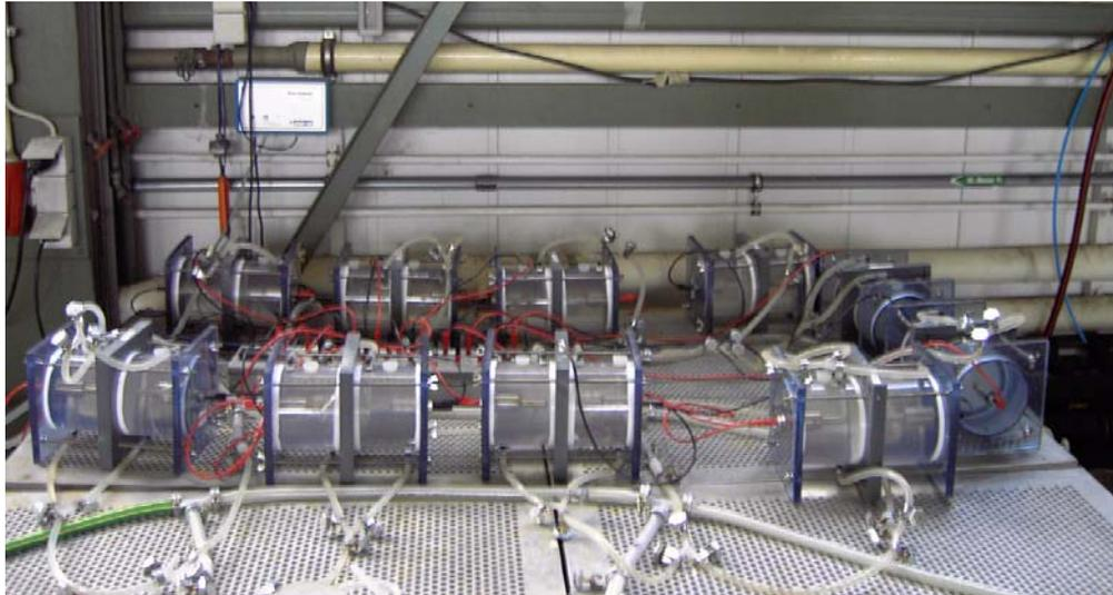
**Abbildung 37:** Versuchsaufbau eines Kreislaufs der E-Feld-Prüfzellen
