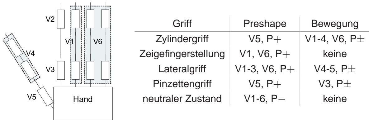
Bild 7.14: Gekoppelte Freiheitsgrade der Prothese: Ventile V1, V4, V6 bedienen mehrere Fluidaktoren gleichzeitig, das Öffnen zusammengehöriger Ventile führt zur Ausführung von Griffarten, die Förderrichtung der Pumpe (P+: in Richtung Aktor, P-: aus Aktor heraus) bewirkt ein Öffnen oder Schließen, Hakengriff: Preshape des Lateralgriffs [362]
