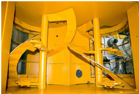
Abb. 3: Sicht auf den Mischraum des Laborzweiwellenmischer mit wendelförmigem Mischwerkzeug
