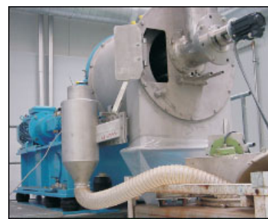
Abbildung 13. Pulsierende Speisung für Schubzentrifugen (Ferrum).
