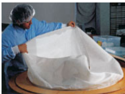
Abbildung 29. Endkontrolle eines Pharma-Grade-Filterbeutels (SEFAR).
