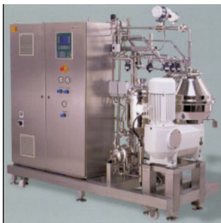
Abbildung 3. Düsenseparator HFC15 als Package Unit (Westfalia Separator).
