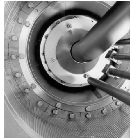
Abbildung 16. Schubzentrifuge mit integrierter Voreindickzone (FERRUM AG).
