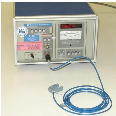
**(a)** Flussmessgerät Transonic T106
