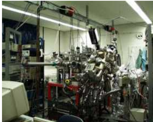
Abbildung 3.9: Eine II-VI MBE Anlage im Institut für Angewandte Physik, Uni Karlsruhe
