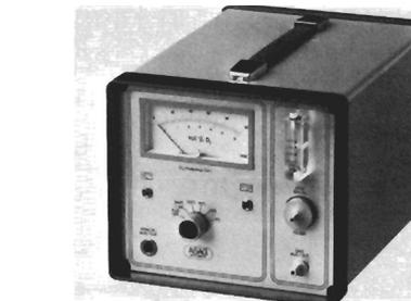
Tragbarer Gasanalysator zur Sauerstoffmessung, Typ OXI
