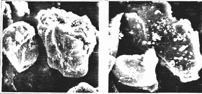
Abb. 2 RIEM-Aufnahme von russ. und schwed. Fe-Erz
