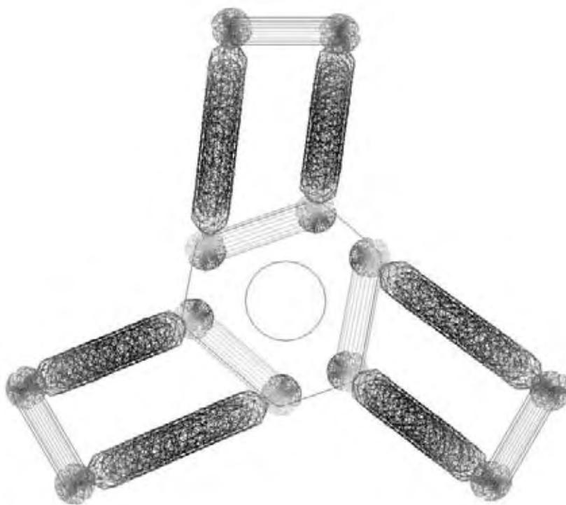
**Abbildung 9.5.:** Draufsicht der PKM, Rotation des Spindelstocks um die z-Achse
