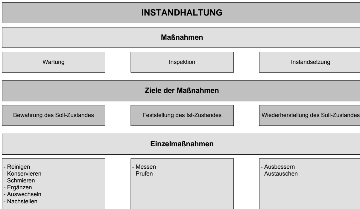
Abbildung 2-1: Maßnahmen der Instandhaltung nach DIN 31051:1985-01 [Nogg04]
