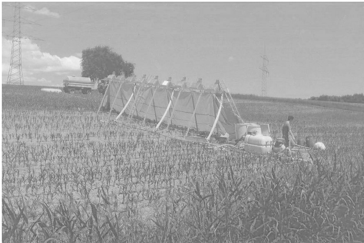
Abbildung 5-8 Einsatz der Beregnungsanlage im Weiherbachgebiet (GERLINGER, 1997).
