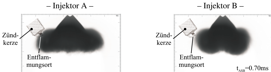
Abb. 7.2: Vergleich der Einspritzstrahlen von Injektor A (links) und Injektor B (rechts) anhand von Schattenrissaufnahmen zum Zeitpunkt t_{ASB} = 0.7 \text{ ms} .
