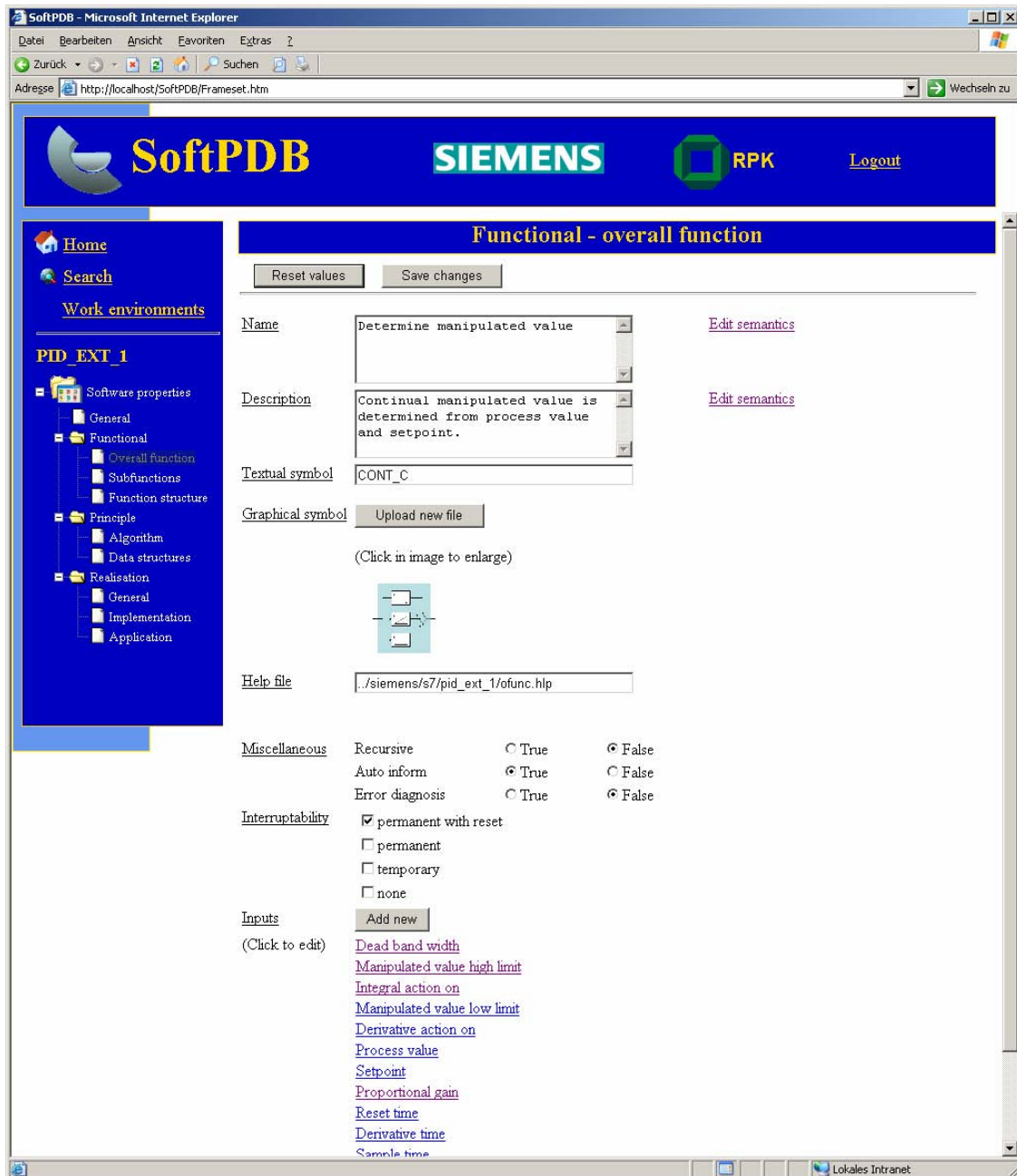
Abb. 6-33: Spezifikation der Gesamtfunktion einer PID-Regelungssoftware
