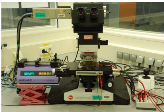
Abb. 4-47: Versuchsaufbau. Links: Spritzenpumpe, Mikroskop, Cmos-Schalter. Rechts: Proben-tisch des Mikroskops mit Magnetspule und darauf abgelegtem mikrofluidischen System. Fluidische Kontaktierung des Systems über Peekschläuche und MicroTight ® Fittings zur Glasspritze und dem Piezoaktor. Piezoaktor ist an der Vorderseite des Proben-tisches angebracht.
