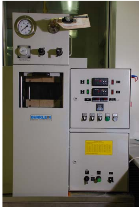
Abb. 3-15: Bürkle Presse LAT 6,0. Auf der rechten Seite befindet sich die Maschinensteuerung, links ist der geöffnete Werkzeugschacht zu sehen.
