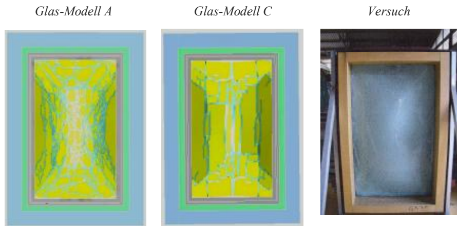
Abb. 9: Rissbilder nach Simulation und Versuch
