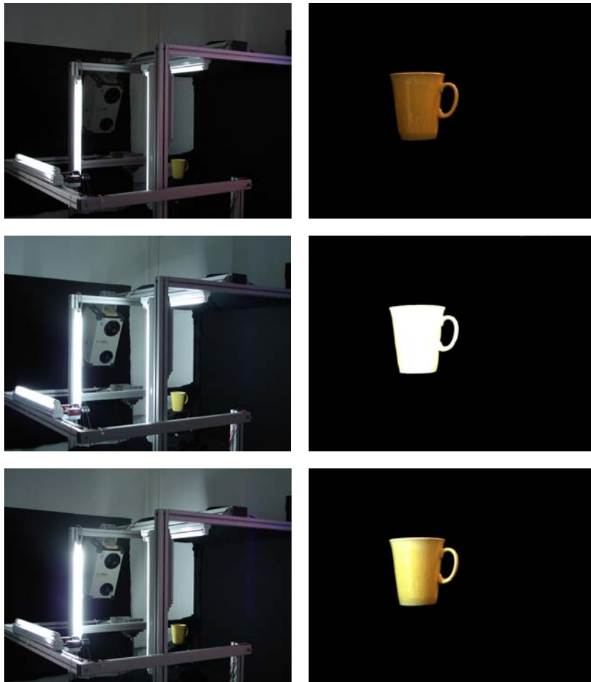
Abbildung 5.8: Unterschiedliche Beleuchtungssituationen in einer Objektmodellierungssequenz (1). Oben : dunkelste Einstellung, Mitte : hellste Einstellung, unten : Lichteinfall von links
