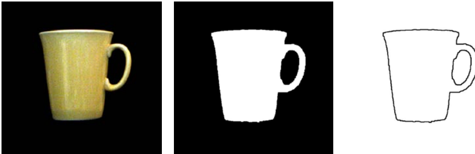
Abbildung 5.18: Kameraaufnahme eines Objektes, daraus extrahierter Objektblob und resultierende Silhouette
