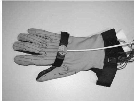
Abbildung 5.14: Datenhandschuh mit integrierter Kraftsensorik (Zöllner (2005)) und magnetfeldbasiertem Positionssensor
