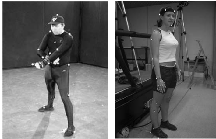
Abbildung 2.8: Markerbasierte Bewegungserfassung mit Kameras. Links Motion Captor-System von Meta Motion (aus: Meta Motion (2006b)). Rechts : das Trackingsystem von VICON in der Anwendung (aus: Stein et al. (2006), S. 14)
