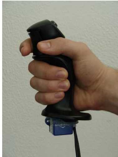
Abbildung 5.12: Joystick mit integriertem Inertialsensor
