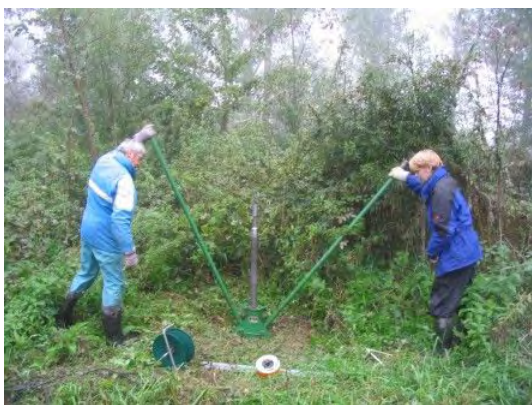
Abbildung 5.2: Probenahme mittels Rammkernsondierung. Messstelle: Auenbereich des Rheins bei Elchesheim-Illingen.
