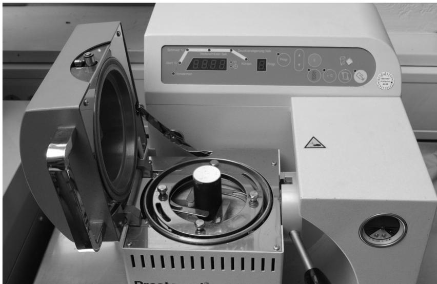
Abbildung 4.2: Vakuumpdruckgussanlage [BauG05]
