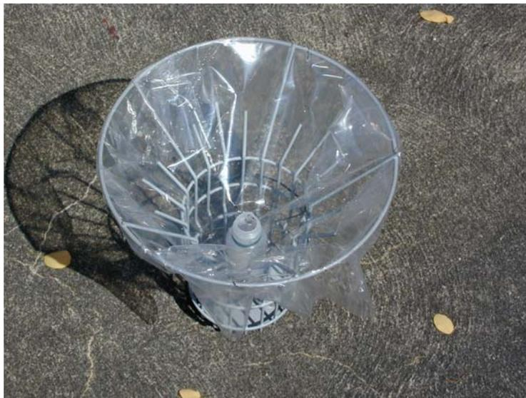
Abb. 3: Vorrichtung zur Beprobung des Straßenabflusses im Gully
