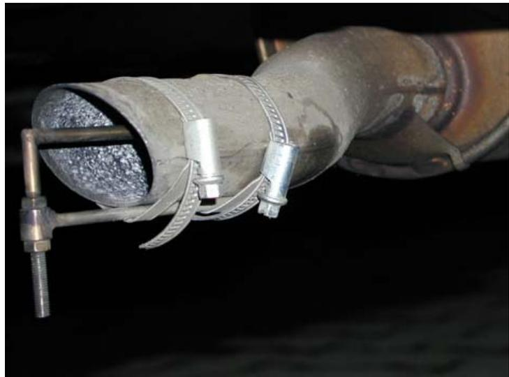
Abb. 1: Beprobung von Partikeln im Auspuff eines Pkw
