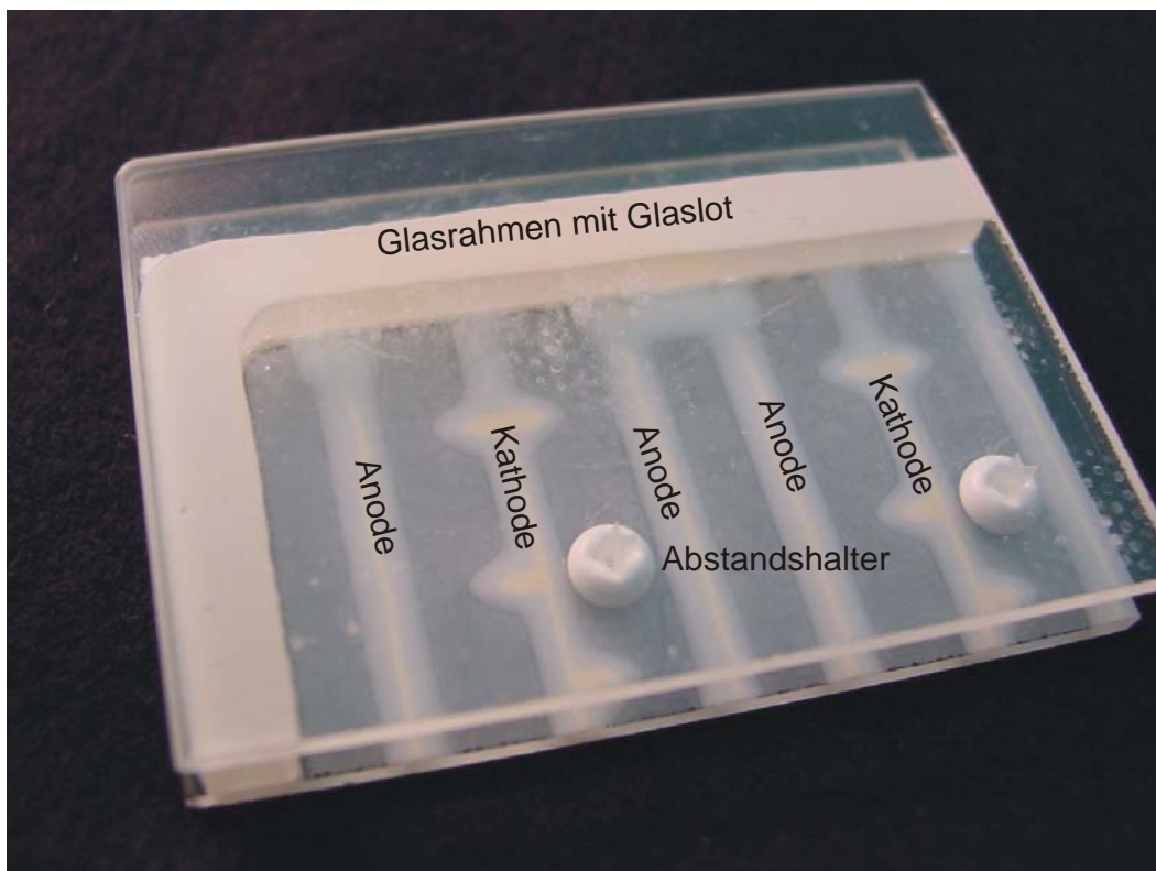
Bild 3.4 Ausschnitt aus einer Planon® der ersten Generation. Der Phosphor wurde entfernt. Zu sehen sind die mit einer dielektrischen Schicht versehenen Elektroden der Lampe. Die Anoden sind als gerade Streifen ausgeführt und kathodenseitig sind die Ansatzspitzen zu erkennen.
