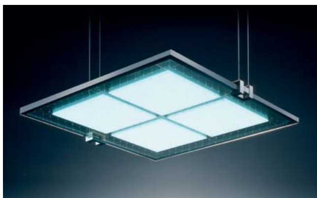
Bild 1.3 PURA von Saint-Gobain als Beispiel einer DBE zur Lichterzeugung. Die hier gezeigte DBE-Lampe hat eine Gesamtgröße von 60 x 60 cm 2 , eine aktive Fläche von 0,2 m 2 und strukturierten Elektroden.
