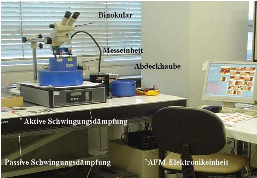
**Abbildung 3.13** Experimenteller Aufbau des Rasterkraftmikroskops [9].
