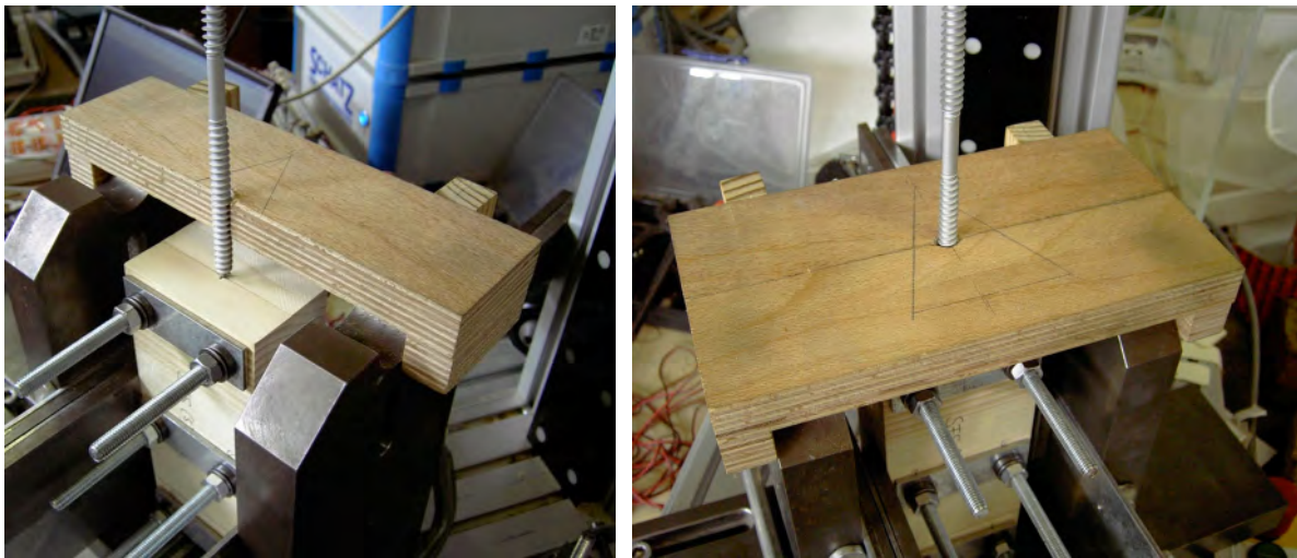
Bild 4-4 Versuchseinrichtung, Schablonen zur Führung der Schraube
