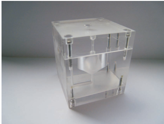
(a) Aus PMMA gefertigte Fluidtauscher mit 10 ml Volumen
