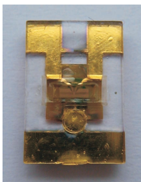
(a) Oberseite eines fertigen SAW Biosensorchips
