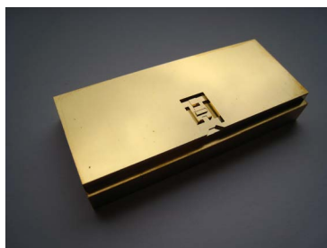
(d) Unteres Abformwerkzeug, Gesamtansicht
