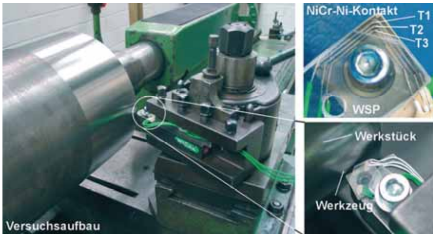
Abbildung 2-12: Versuchsaufbau zur Temperaturmessung beim Drehen [Wei-05_1]
