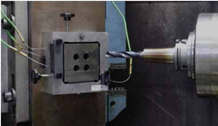
Abbildung 4-8: Versuchsaufbau zur Messung des Wärmeeintrags
