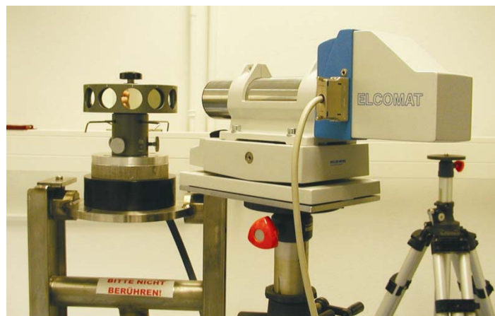
Bild 6-12: Kalibrierung des Drehtisch DT-2P am Dreharm, Spiegelpolygon und Autokollimator
