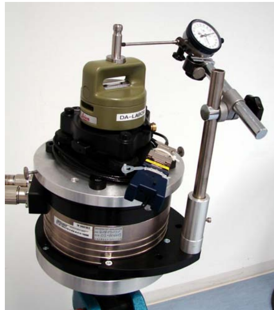
Bild 6-8: Drehmotor mit Aufnahme zur Messung der Exzentrizität
