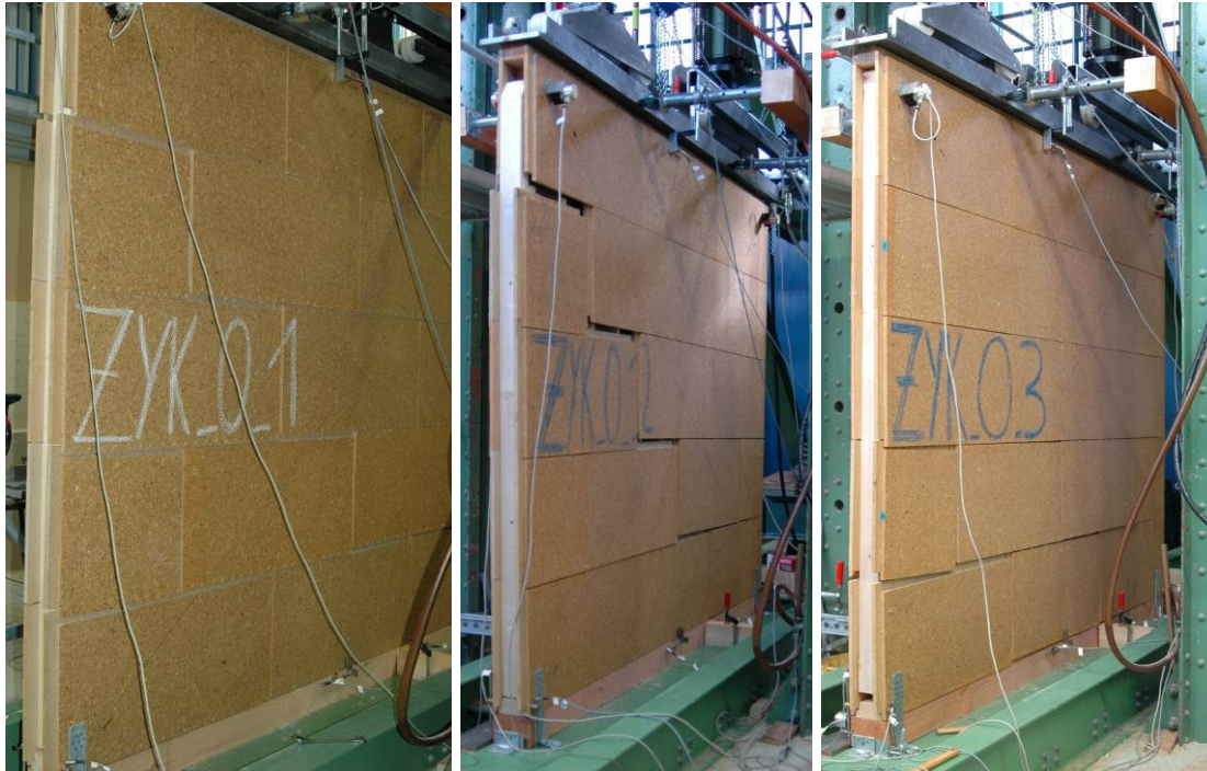
Bild 5-26: Versagensbild der Versuche ohne zusätzliche Auflast
