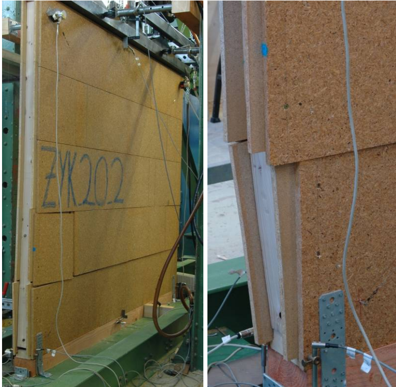
Bild 5-28: Versagensbild eines Versuches mit zusätzlicher Auflast 20 kN/m (links), Verschiebungen in der untersten Fuge (rechts)
