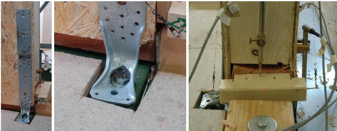
Bild 5-33: Verlängerter Fundamentwinkel (links), Durchstanzen der Schraube (Mitte), Abheben des Stiels (rechts)
