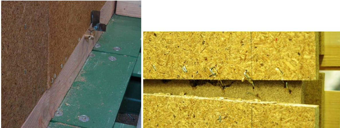
Bild 5-24: Klammersauszug in der untersten Elementfuge beim Versuch PO_10_2 (links) Klammersauszug beim Versuch PO_10_3 (rechts)
