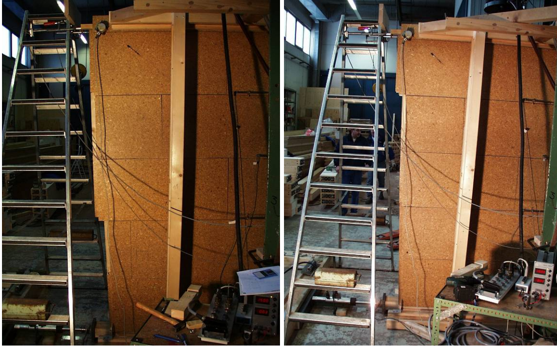
Bild 4-2: Gleiten der Lagerfuge bei Versuchen 2006
