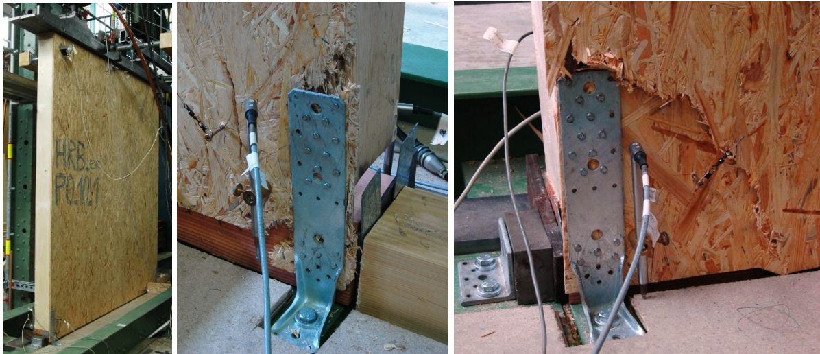
Bild 5-31: Holztafelbauwand vor dem Versuch (links) Versagen der Beplankung auf der Zugseite (Mitte) sowie auf der Druckseite (rechts)
