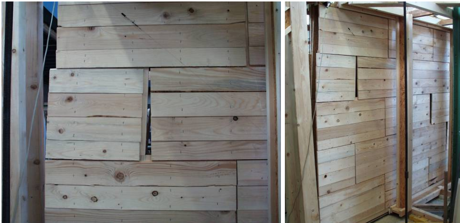
Bild 4-1: Schubverformungen von HIB – Elementen bei Versuchen 2006
