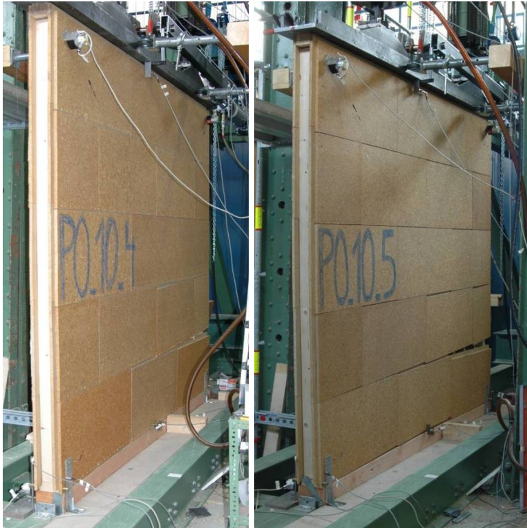
Bild 5-21: Prüfkörper PO_10_4 und PO_10_5 nach dem Versagen
