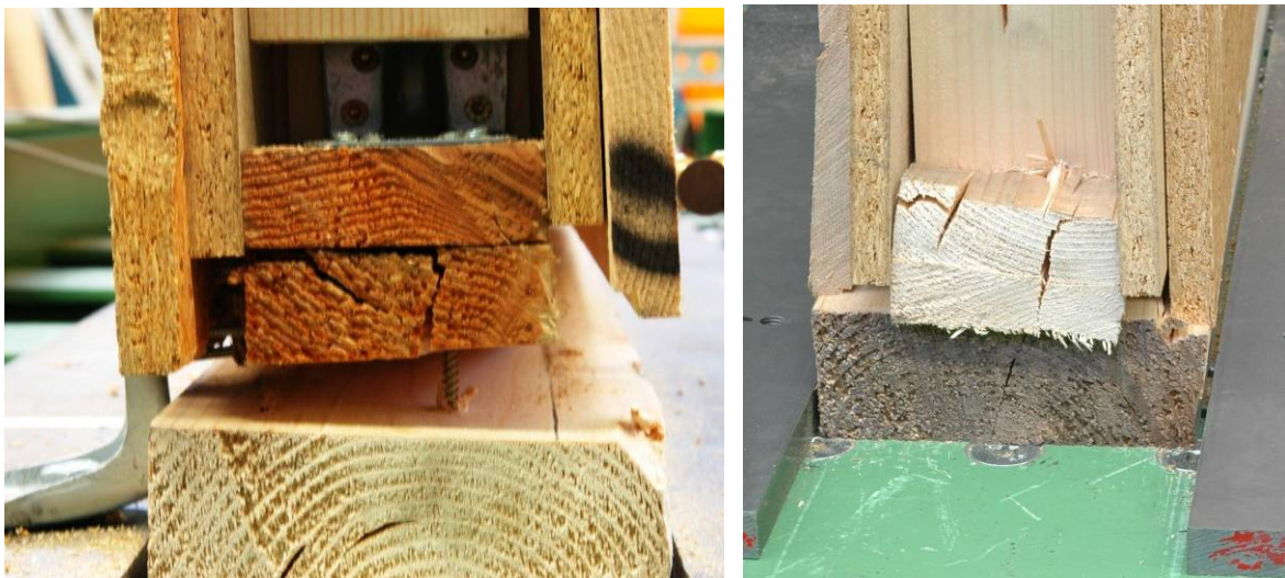
Bild 5-9: Nadelholzschwelle mit aufgeschraubten Brettern
