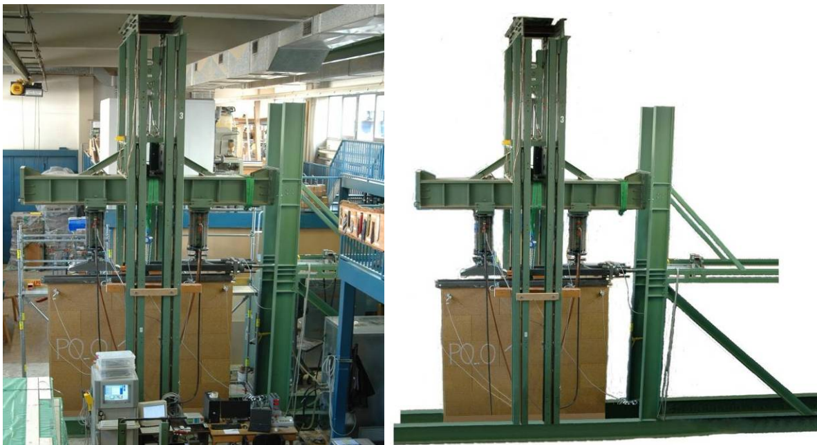
Bild 3-5: Prüfraumen mit eingebauter HIB-Wandscheibe
