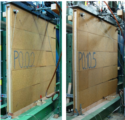
Bild 7: Prüfwände nach dem Versuch mit monotoner Belastung
