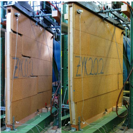
Bild 11: Versuchswände nach zyklischer Belastung
