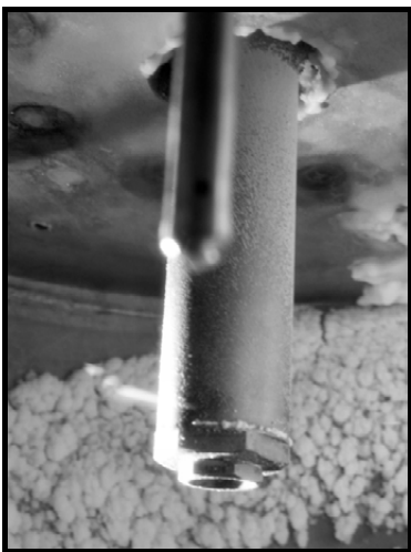
Bild 5.40: Düse ohne Isolierung nach ca. 75min. Betriebsdauer
