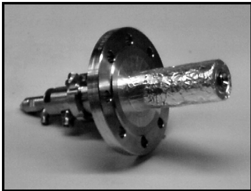
Bild 5.38: Düse der kontinuierlichen Flash-Kristallisation mit wärmeisoliertem Düsenschaft, die Isolierung besteht aus einem 1cm dicken nanoporösen Isoliermaterial vom Typ WDS ® Ultra ( \lambda = 0,02\text{W/mK} ); diese ist zum Schutz vor Feuchtigkeit mit Aluminiumfolie ummantelt
