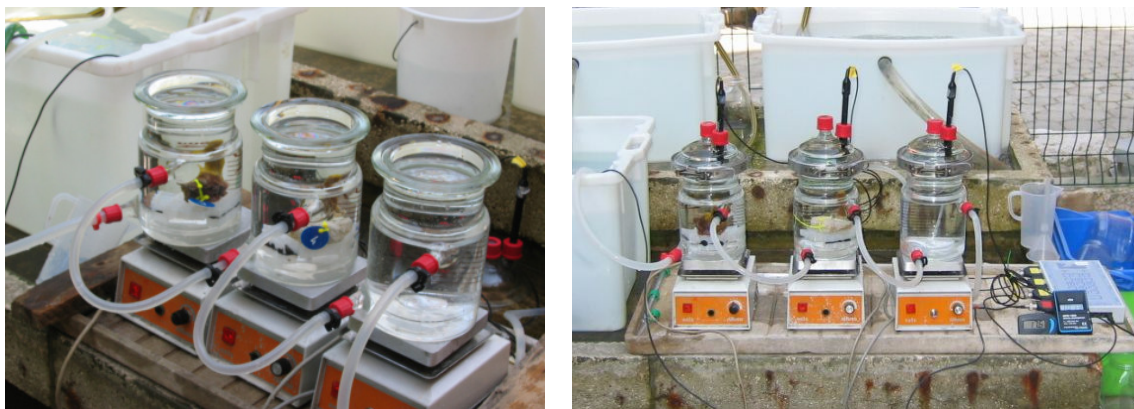
Abbildung 4.6: Versuchsaufbau zur Durchführung der Sauerstoffverbrauchsmessungen in Rovinj, Kroatien.
