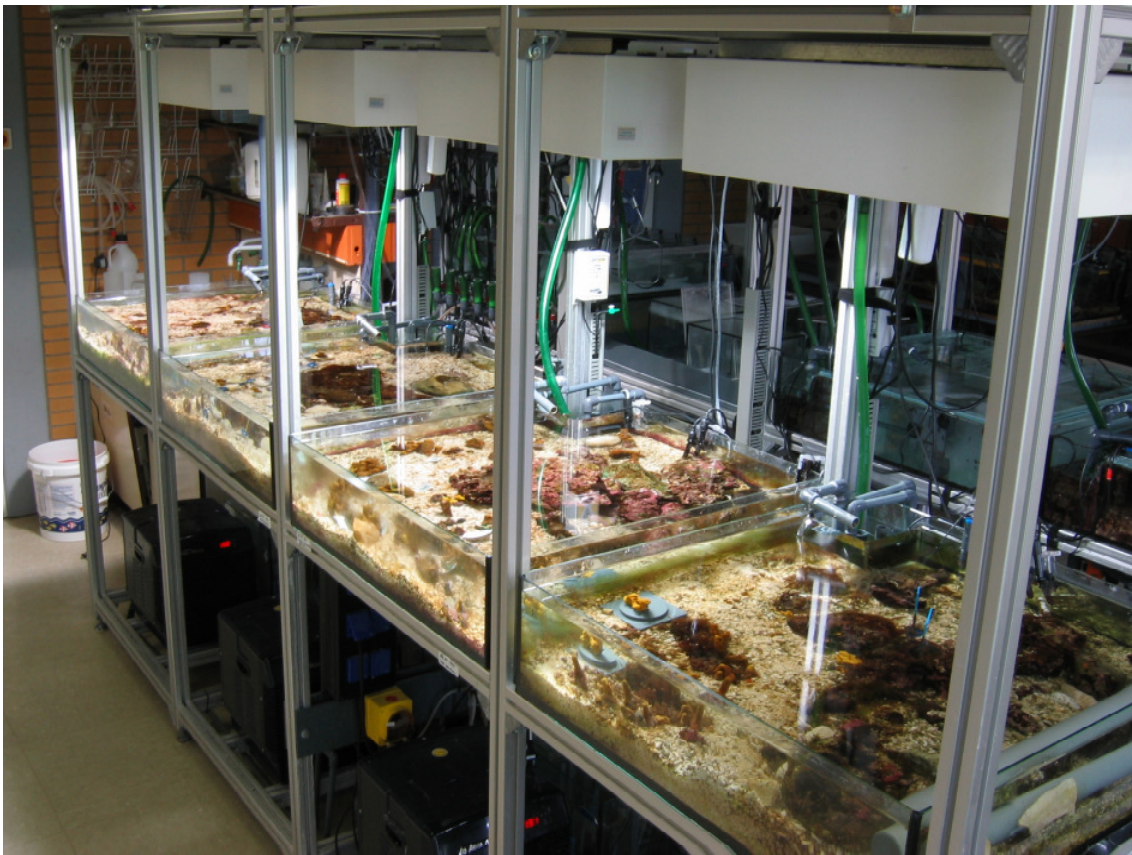
Abbildung 4.2: Schwammkultivierungsanlage am Lehrstuhl für technische Biologie, Institut für Bio- und Lebensmitteltechnik, Universität Karlsruhe (TH)
