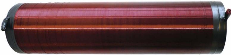
Bild 4.40: NF-Spule in realer Ausführung ( $\varnothing=16\text{ cm}$ ;  $L_{NF}=51,88\text{ mH}$ )
