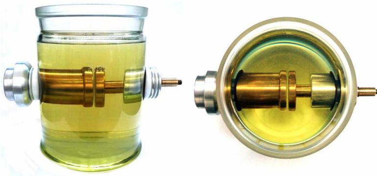
Bild 4.44: Prüfgefäß für flüssige Isolierstoffe
