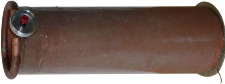
Bild 4.43: HF-Spule in realer Ausführung ( $\varnothing=16,5\text{ cm}$ ;  $L_{\text{HF}}=3,36\text{ mH}$ )
