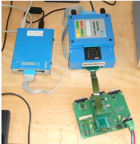
Abbildung 6.3: Physikalischer Aufbau der Emulatorsystems iC3000 ActiveEmulator (links) und ActivePOD II (oben rechts) mit Testplatine zur Lenkscheinwerferansteuerung (unten).
