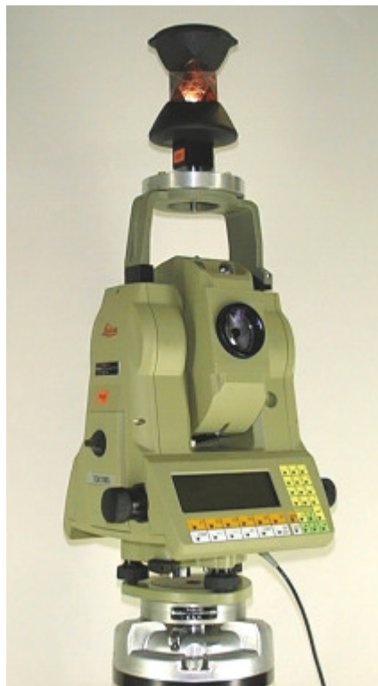
Abb. 4: Montierung des Reflektors
