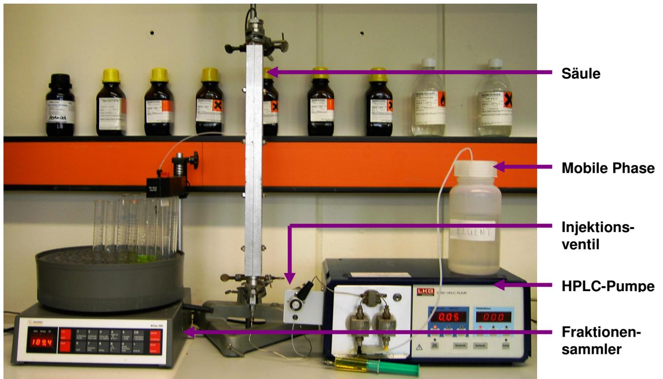
Abb. 40: Foto der Versuchsanlage „Reaktorversuch“
